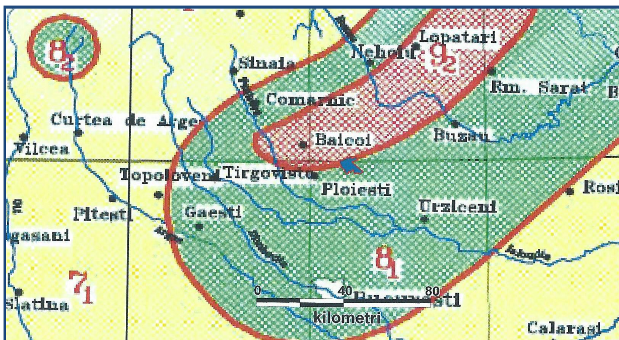
Harta: Macrozonarea seismică a României S.R.1100/1-93
